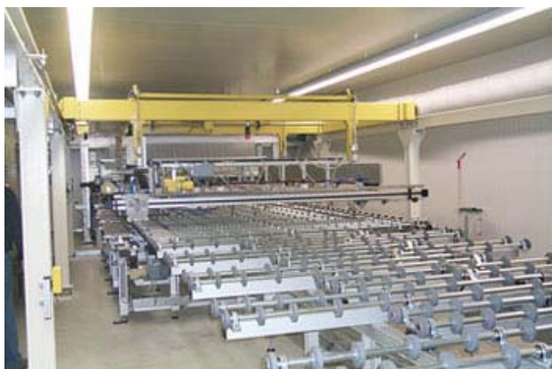
Sala blanca para ensamblaje de vidrio y corte del PVB
